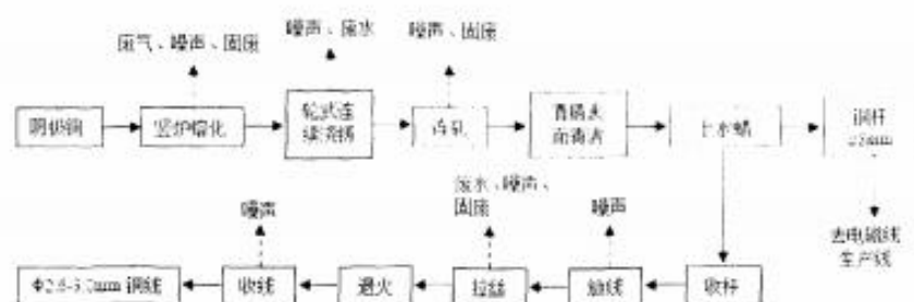
高强高导高韧铜线产品生产工艺流程
